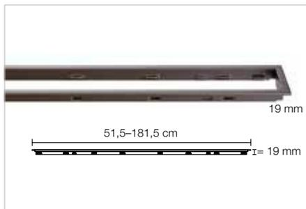
Schlüter-KERDI-LINE são remates de perfil opcionalmente em aço inoxidável polido de alto brilho ou aço inoxidável termolacado com coberturas clássicas, correspondentes aos corpos do canal Schlüter-KERDI-LINE. O remate de suporte é regulável de forma contínua em altura para material de suporte de 3–25 mm. As coberturas estão disponíveis nas variantes de design SOLID (A), SQUARE (B) e FRAMED TILE (C).
