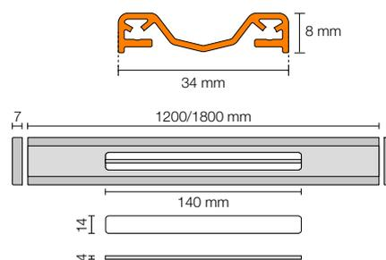
Adequado para espessuras de revestimento de 6–15 mm (com DITRA ou DITRA-HEAT) e 6–12 mm (com DITRA-HEAT-DUO).
