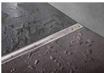
O Schlüter-KERDI-LINE-VARIO COVE 34 é um perfil de escoamento encurtável côncavo para a utilização com uma peça de escoamento KERDI-LINE-VARIO-H. Está disponível nas qualidades de material de aço inoxidável escovado V4A (material n.º 1.4404 = AISI 316L) e alumínio com termolacagem de elevada qualidade.
