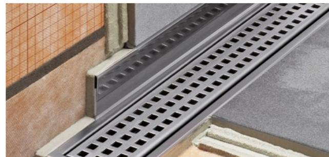
Schlüter-SHOWERPROFILE-R é um perfil de ligação à parede de duas peças, para o revestimento da área da parede de um escoamento em linha que fica exposto devido à inclinação. A superfície visível do perfil é de aço inoxidável escovado. O lado traseiro está equipado com um geotêxtil para fixação no cimento cola. A estrutura em 2 peças permite ajustar Schlüter-SHOWERPROFILE-R de forma contínua em altura, numa área entre aprox. 23 e 45 mm (em duas versões).
